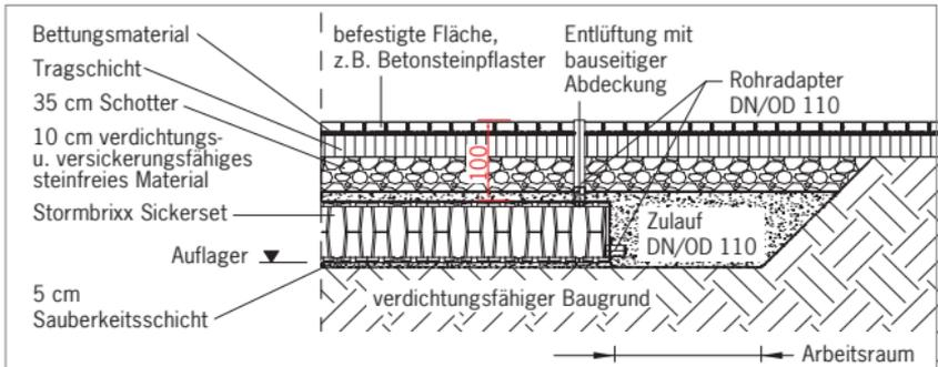
Einbaubeispiel: ACO Stormbrixx Rigolensystem unter einer Rasenfläche <sup>1)</sup>
