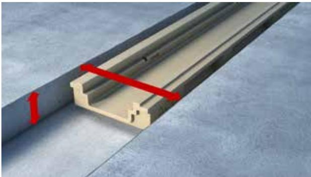
Höhenanpassung auf gewünschtes Niveau mittels Laser oder Richtschnur. Flanschhöhe muss der Höhe der Beschichtungsebene gleichen. (Unterkante Beschichtungsflansch = Oberkante Rohbetondecke) Die Höhe der Rinnenoberkante (Zarge) soll so ausgerichtet werden, dass die Zarge keinen Hochpunkt darstellt um eine funktionierende Entwässerung zu gewährleisten.
