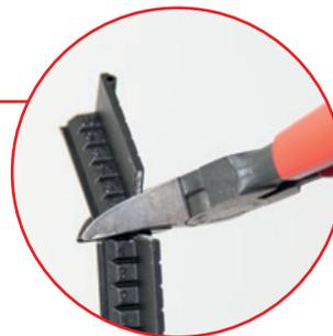
bei Bedarf mit Seitenschneider kürzen
