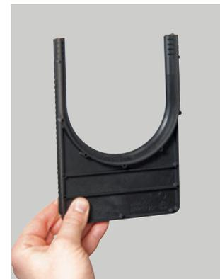
Für den Anschluss der **Rinnenelemente Typ 0–10** wird der Anschlussadapter **Kurzform** (Art.-Nr. 132382) benötigt. Dieser muss bei Anschluss der **Typen 0–9** entsprechend der vorgegebenen Markierung an beiden Schenkeln gekürzt werden.
