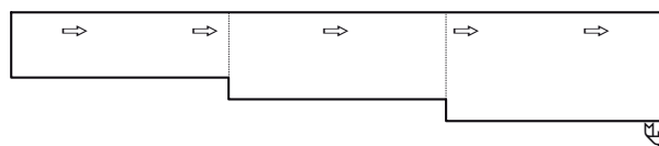
Stufengefälle (Rinnenkörper mit unterschiedlichen Bauhöhen)
