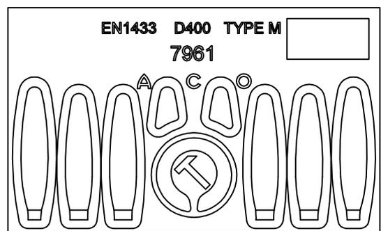
Einlaufquerschnitt: 148 cm<sup>2</sup> / m
