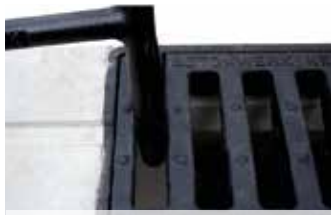
1. Ansetzen des Bedienschlüssels
