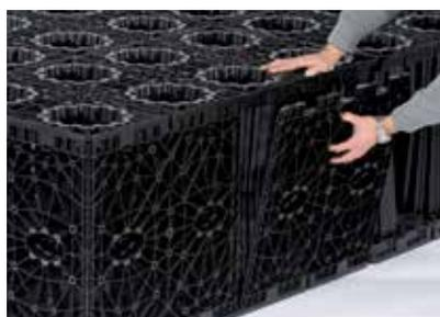
Beim Einbau der Seitenwände ist darauf zu achten, dass die Positionierungslaschen zuerst im Grundelement montiert werden.
