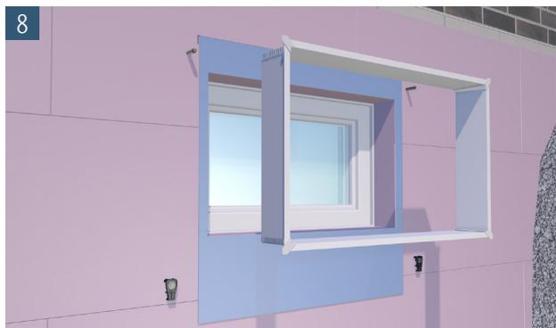
8 Klicken Sie das Dämmungsanschlussprofil in die vorge-sehene Nut des Leibungskellerfensters ein
