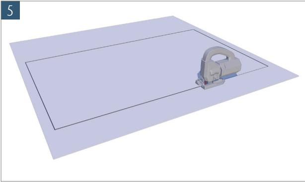
5 Nehmen Sie die Rückwand aus dem Lichtschacht. Sägen Sie die Fensterausparung in die Rückwand
