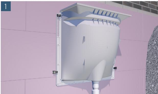
1 Montieren Sie den Lichtschacht und richten diesen final in der Höhe aus
