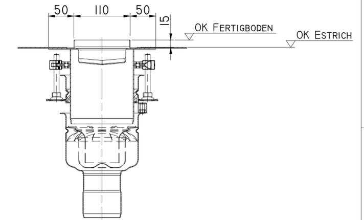
SHOWERDRAIN PUBLIC 110 + BODENABLAUF SENKRECHT MIT PRESSDICHTUNGSFLANSCH
