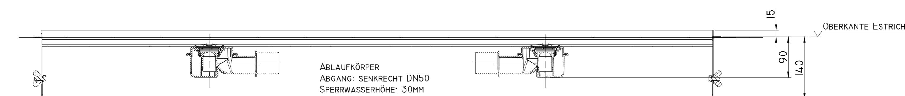
EINBAUHÖHE OK FERTIGBODEN: MIN. 45MM - MAX. 155MM
