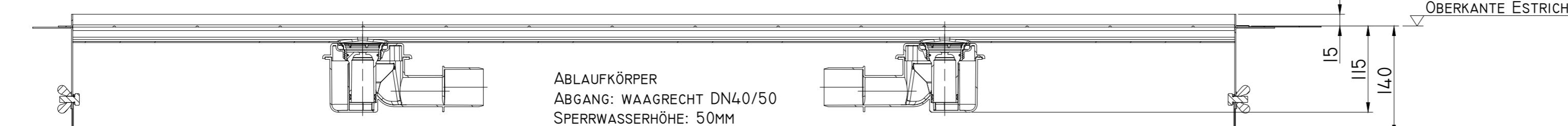
EINBAUHÖHE OK FERTIGBODEN: MIN. 130MM - MAX. 155MM
