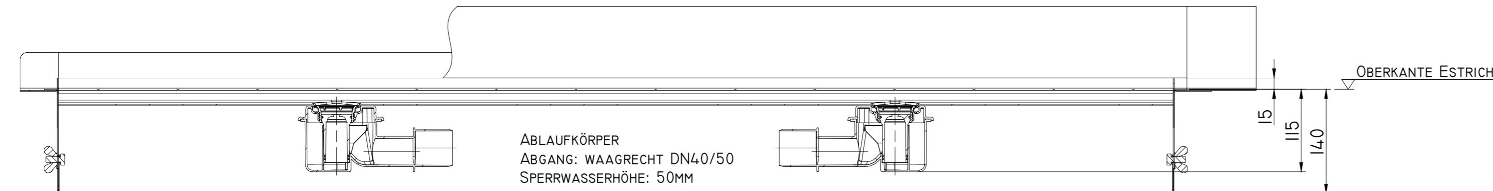
EINBAUHÖHE OK FERTIGBODEN: MIN. 130MM - MAX. 155MM
