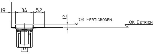
SHOWERDRAIN E+ MIT WANDAUFKANTUNG EINBAUHÖHE OK ESTRICH: MIN. 66MM - MAX. 140MM
