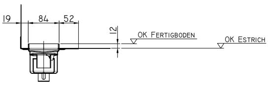
SHOWERDRAIN E+ MIT WANDAUFKANTUNG EINBAUHÖHE OK ESTRICH: MIN. 15MM - MAX. 140MM
