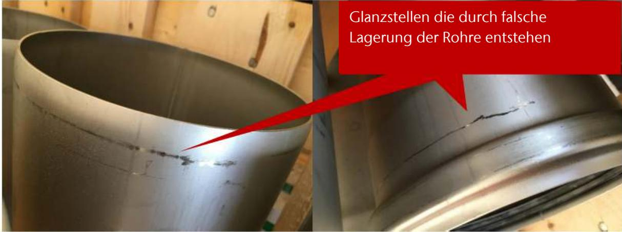
Glanzstellen die durch falsche Lagerung der Rohre entstehen
