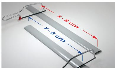
4. Die zwei längeren Profilstücke werden auf X-Maß minus 8 cm zugesägt. Die zwei kürzeren Profilstücke werden auf Y-Maß minus 8 cm zugesägt.
