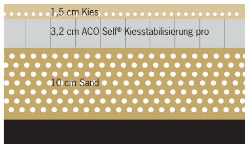
Für Geh- und Fahrradwege eine eingebnete Sandschicht von 10 cm.
