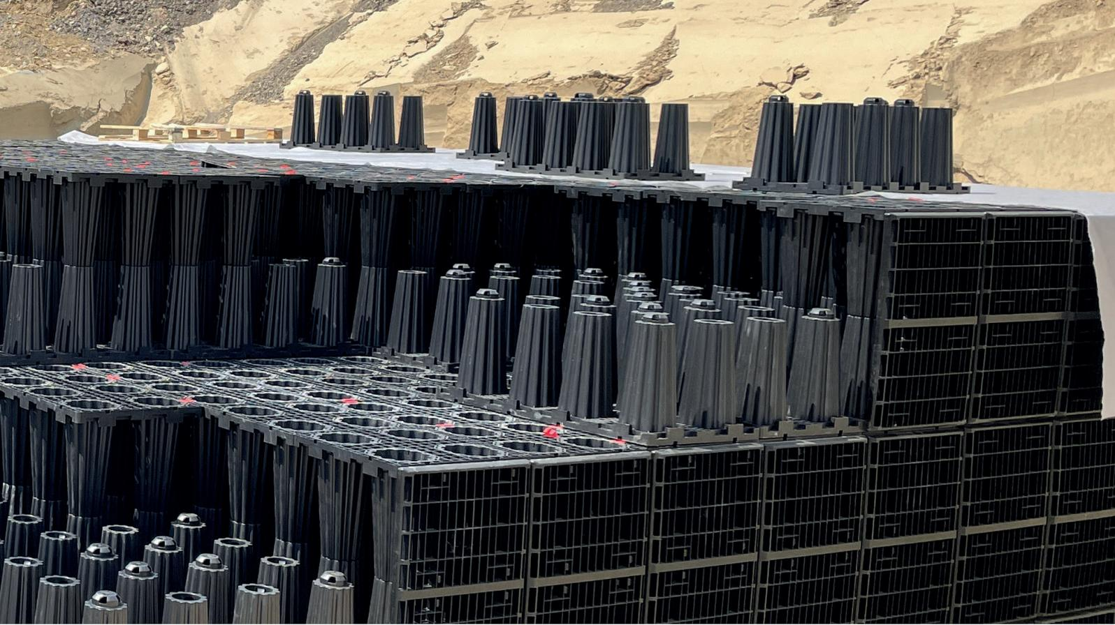
Die Modularität von ACO Stormbrixx bringt für geringe Einbauhöhen weitere Vorteile: die Grundelemente können mit Hilfe einer Abdeckplatte als halbe Lage verbaut werden. Halbe Seitenwände vervollständigen das System. Die Abdeckplatte ist zu beiden Systemen kompatibel und die Höhe des Blocks wird durch ihren Einsatz nahezu um die Hälfte reduziert.
