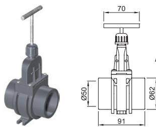
Absperrschieber DN 50 | <ul style="list-style-type: none"> <li>Fettabscheider</li> <li>□ LipuMobil-P 0,8</li> </ul> | <ul style="list-style-type: none"> <li>Aus PVC</li> <li>DN 50</li> <li>beidseitiges Muffenende</li> <li>Gewicht: 0,40 kg</li> </ul> | 0175.18.33  | 200,90      |
