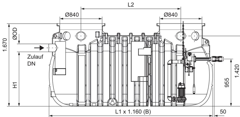
**Auftriebssicher** bis Höhe 1.650 mm (gemessen von Behälterboden)
