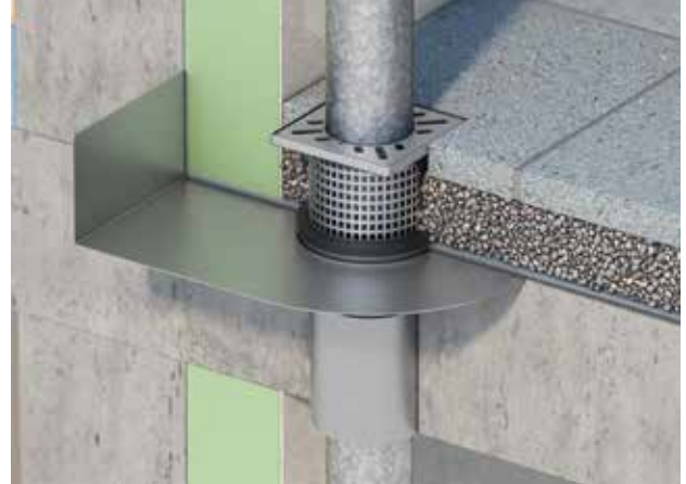
Balkonablauf mit Wandaufkantung für den Einbau in eine Balkonplatte mit Flüssigkunststoffabdichtung und zusätzlicher Belagsoberfläche im Wärmedämmverbundsystem
