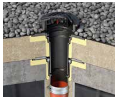
Flachdachablauf Spin aus Gusseisen mit zwei Pressdichtungsflanschen
