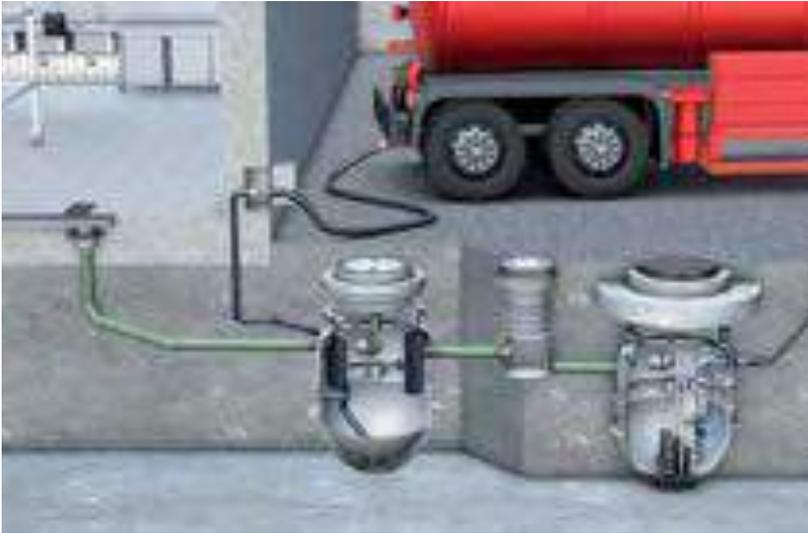
Sind die baulichen Gegebenheiten sehr beengt, so ist es in manchen Fällen notwendig, statt einer Hebeanlage im Gebäude, eine Pumpstation außerhalb des Gebäudes zu verbauen.
