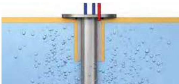
Über einen Kompressor wird permanent Luft in das Staurohr eingeblasen. Die am Ende des Staurohrs aufsteigenden Luftblasen sorgen für eine ständige Bewegung unterhalb des Staurohrs, so dass sich keine schwimmdeckenbildenden Medien (z. B. Restfett aus dem Abscheider) festsetzen können. Dadurch wird eine sehr zuverlässig arbeitende Niveaumessung gewährleistet.
