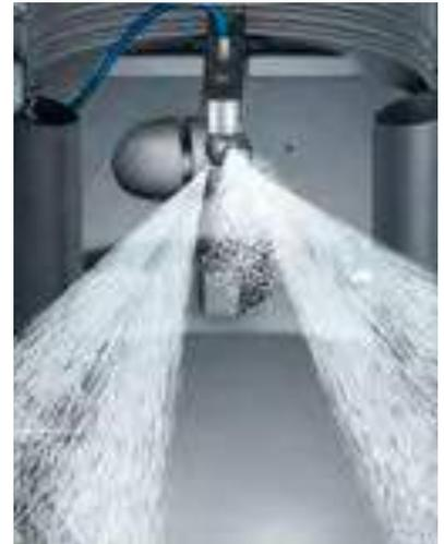
Hochdruckinnenreinigung bei einem Fettabscheider zur rückstandsarmen Entsorgung
