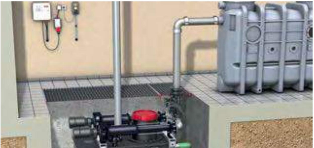
**Anwendungsfall: Zu niedriger Zulaufanschluss vor Fettabscheideranlagen**
