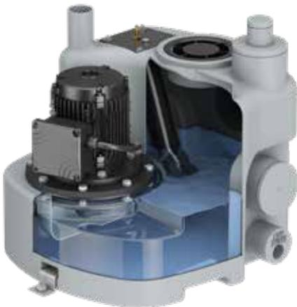
Über die Zulaufleitung wird dem Sammelbehälter Abwasser zugeführt. Die Pumpentechnik fördert noch kein Abwasser, da sich im Staurohr noch kein Druck aufgebaut hat.
