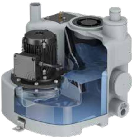
Der Abwasserspiegel in der Hebeanlage steigt an, durch das ansteigende Abwasser kommt es im Staurohr und der angeschlossenen Steuerleitung durch Luftverdrängung zu einer Druckerhöhung. Diese wird durch den Schaltkasten realisiert. Eine Aktivierung der Pumpe erfolgt noch nicht. Erreicht der Wasserspiegel eine bestimmte Höhe (Einschaltpunkt) und somit einen bestimmten Druck in der Steuerleitung, so wird die Pumpentechnik durch die Steuerung aktiviert.
