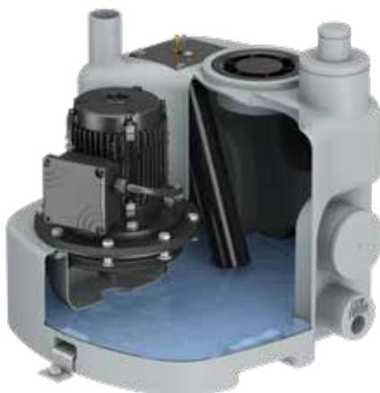
Abwasser wird so lange gefördert, bis der Wasserspiegel so weit sinkt, dass die Pumpentechnik aufgrund des niedrigen Drucks (Ausschaltpunkt) wieder deaktiviert wird.
