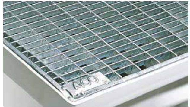
Maschenrost, Maschenweite 30 x 10 mm, begehbar bis 1,5 kN, befahrbar, Radlast bis 9 kN
