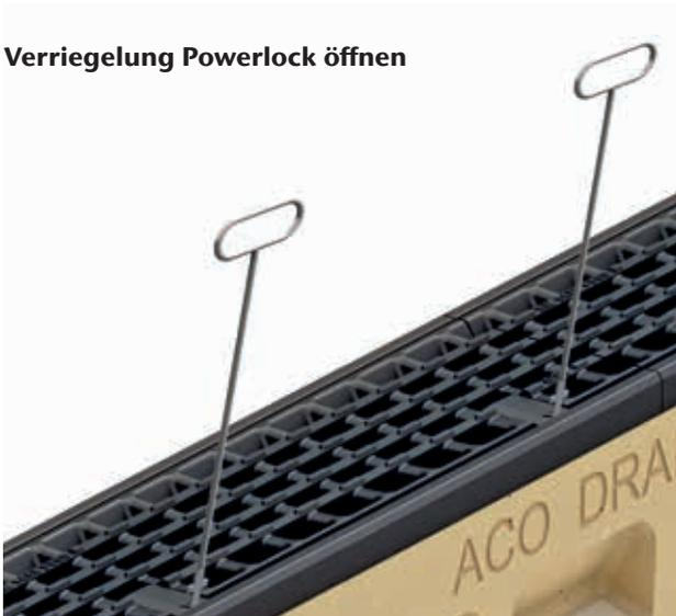
Der Rost kann nur durch das manuelle Entriegeln mithilfe von zwei Rosthaken wieder aus der Rinne entnommen werden.
