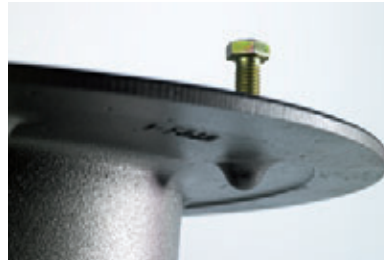
Schraube im Flansch im Sackloch, kein durchgehendes Gewindeloch im Flansch, hierdurch sichere, dauerhafte Abdichtung
