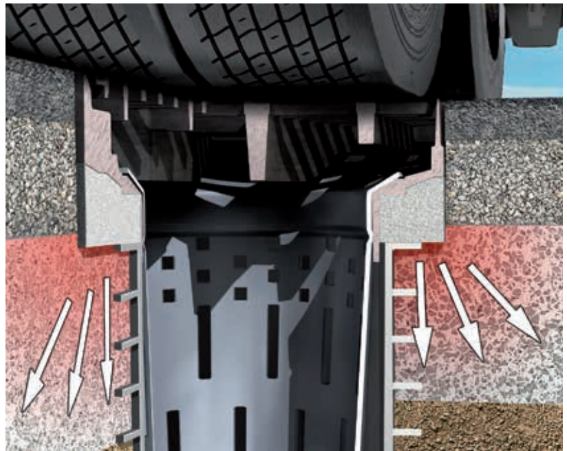
Auf der Rahmenunterseite der Combipoint PP Aufsätze befindet sich eine umlaufende Gusskante, die sich aussteifend in die Kunststoffoberteile einpasst.
