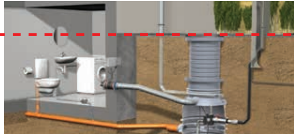
Schutz gegen Rückstau, wenn der Kanal höher liegt als die Entwässerungsgegenstände
