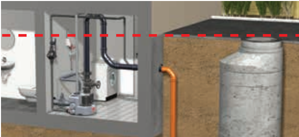
Schutz gegen Rückstau bei Gefälle zum Kanal durch eine Abwasserhebeanlage in Mehrfamilienhäusern, Gewerbeobjekten und Einfamilienhäusern mit Einliegerwohnung
