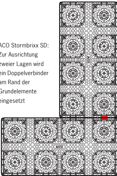
ACO Stormbrixx SD: Zwei zusammengesteckte Verbinder sichern die Ausrichtung der Pylonen zweier Einbaulagen
