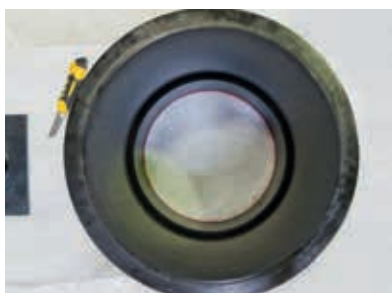
Anzeichnen des Innendurchmessers
