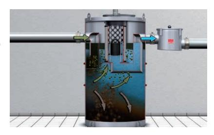
Funktionsprinzip: Leichtflüssigkeit sammelt sich im Abscheider an der Oberfläche und Schwerstoffe (Schlamm) sinken zu Boden.
