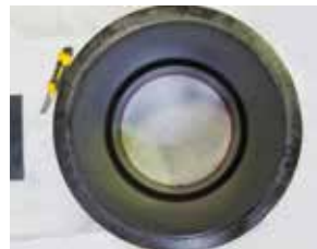
Anzeichnen des Innendurchmessers
