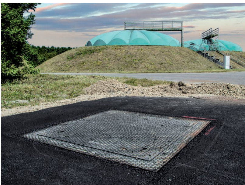
Gussabdeckung tagwasserdicht mit Öffnungshilfe, Belastungsklasse D400, lichte Weite 1000 x 1000 mm, München
