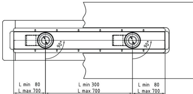
Für Ablaufwerte nach DIN EN 1253-1 darf der maximale Fließweg des Wassers 700 mm NICHT überschreiten. Die Angabe der Position des Stutzens erfolgt entgegen dem Uhrzeigersinn. Bei hinterer Wandaufkantung ist KEIN Stutzenabgang Richtung Wandaufkantung möglich.
