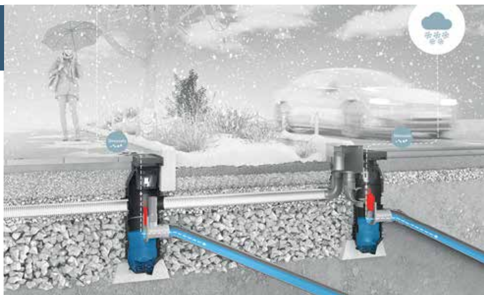
Abbildung 4: Winterbetrieb: Trennschieber sind geöffnet – Ablauf in den Kanal
