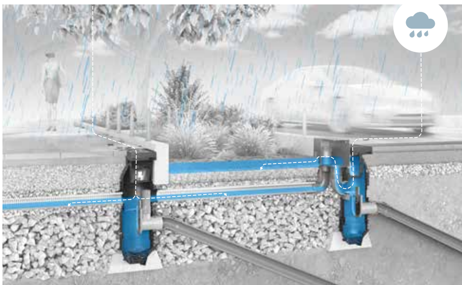
Abbildung 2: Regenereignis setzt ein – Schwammstadt beginnt sich zu füllen
